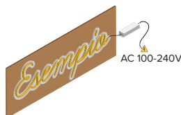
FIGURA 3 esempio di appensione a parete
